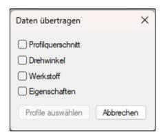
Profilquerschnitt: Mit dieser Option wird der Profilquerschnitt / Profiltyp übertragen.
