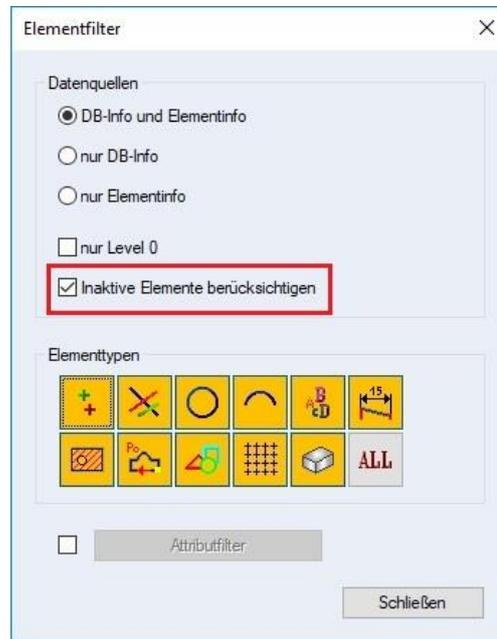
Wen die in der unteren Abbildung eingekreisten Elemente in der Layer/Gruppen-Schaltung ausgeschaltet sind, also nicht sichtbar werden diese Elemente nicht in der Stückliste ausgegeben:
