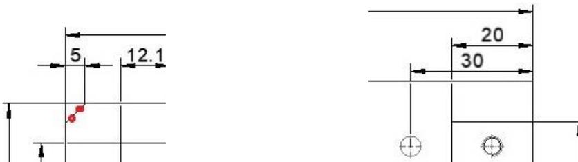
So wird sichergestellt, dass die Bemaßung der Kante erfolgt, so dass bei einer Änderung der Fase im Modelbereich auch diese neu Bemaßt wird.
