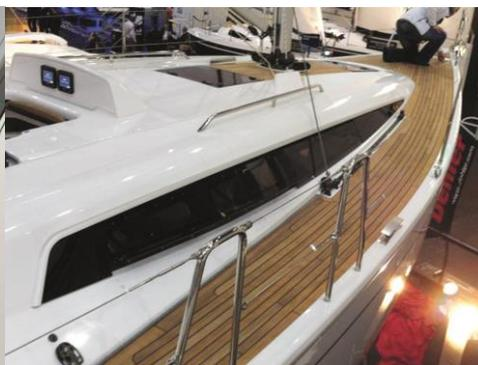
3D-gebogene Zierleisten für die Segelyacht Dehler 38 konstruierte FKM mit MegaCAD.
